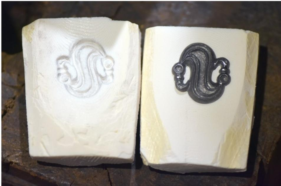
*Fig. 2 - Impronta del modello in piombo nell'osso di seppia.*
