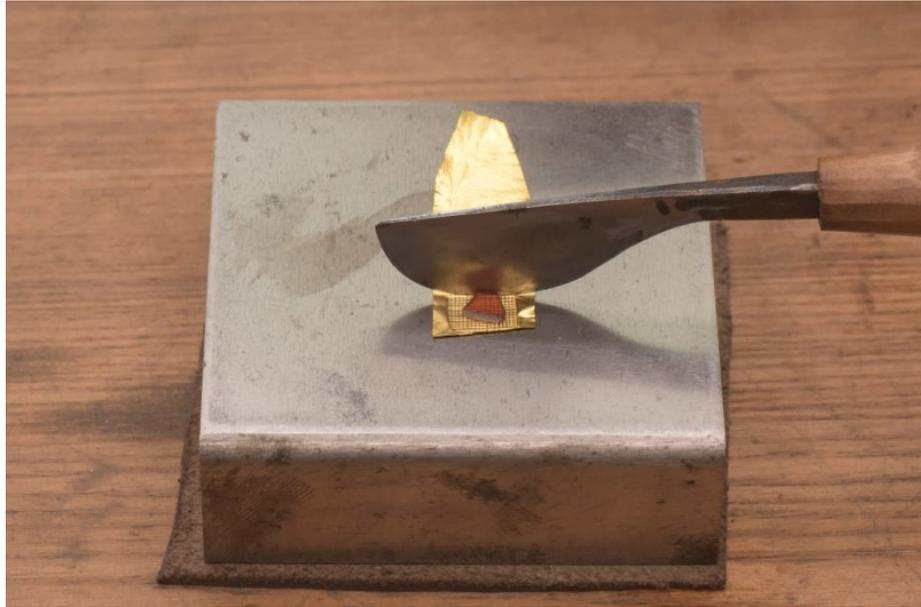
*Fig 10 - Taglio della lamina d'oro lungo i bordi del granato.*
